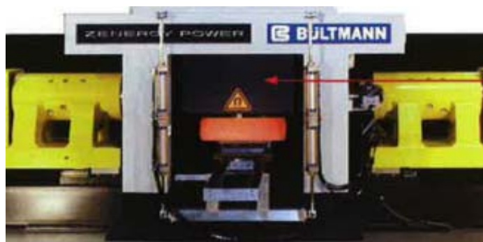
図 5 非磁性体でも渦電流加熱を容易にした超電導炉。金属を赤熱させることも可能。
