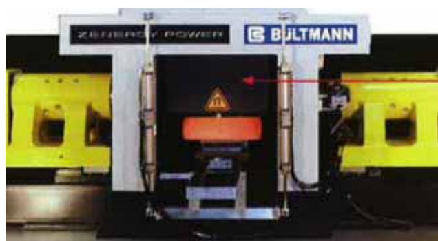
図 6 実用化された超電導加熱炉。実験のため銅を赤熱するまで加熱した。 この時、超電導部分と赤熱部の温度差は 1000 °C 程度と推定される。
