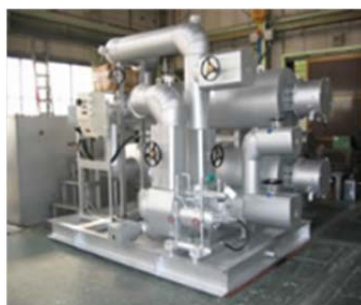
図 5 200 kW ヒータの例
