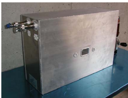
図 5 次世代線材を用いた小型超電導磁石
