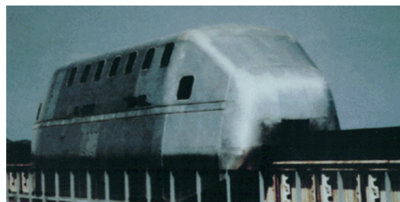
図 5 車載冷凍機を搭載した ML-500R
