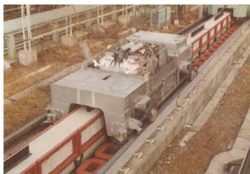
図3 完全非接触浮上走行に成功した ML100A
