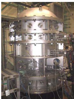
図4 超電導バルク/永久磁石軸受け型フライホイールエネルギー貯蔵装置の構造 (NEDO, ISTE, IHI)
