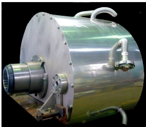
図4 400 kW級船舶推進用HTSモータ (250回転毎分)
