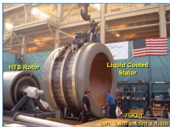
図1 組み立て中の36.5 MW船用モータ (AMSC社のご好意による)
