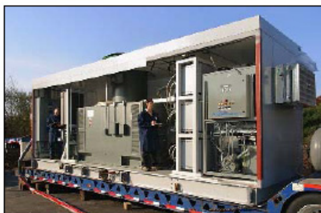
図2 HTS回転機を用いた同期調相機 —初めて商品化されたHTS回転機 (AMSC社のご好意による)
