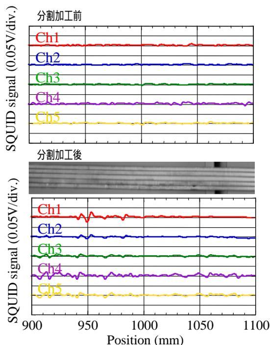
図 3 超電導テープ線材の検査例
