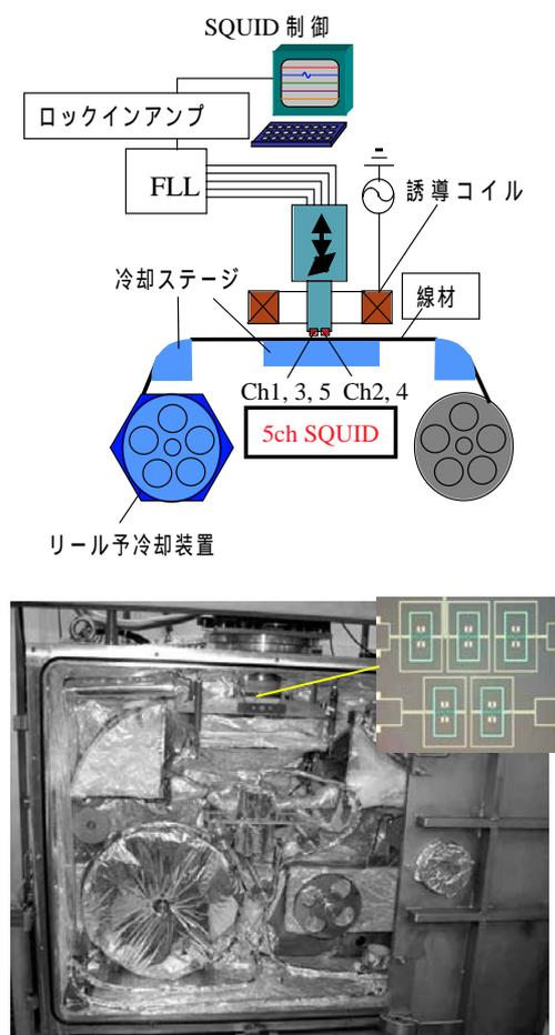
図 2 システム構成と真空チャンバー内およびグラジオメータアレーの写真
