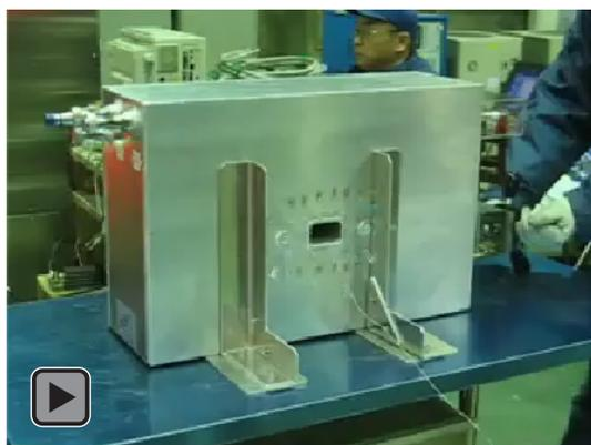
この超電導磁石は、コイル温度 50K において 1T 以上の磁場を発生することができます。また、高温超電導コイルの周囲に配置した金属の熱容量を利用することと、断熱容器内部に設置した活性炭で容器内の真空度を保持する工夫により、コイル温度 50 K 以下を 9 時間保持できることを確認しました。この保冷能力によって、本超電導磁石は励磁電源や冷凍機を切り離れた後も長時間に渡る磁場発生が可能となりました。これまで超電導につきものであった冷凍という重荷を切り離したことになります。これにより、従来の超電導磁石では考えられなかった、永久磁石のように持ち運びが自在で取り扱いが容易な、超電導磁石の新しい形態を実現しました。まだ磁石のサイズや発生磁場もリニアモーターカーで使えるスペックには至っておりませんが、開発課題も多々ありますが、
