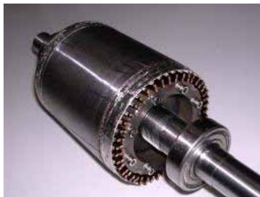
図1 試作した高温超電導かご型回転子 外観写真
