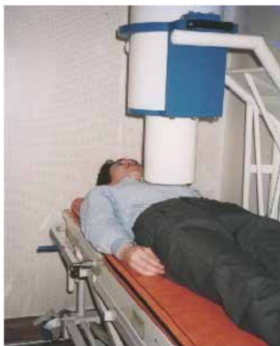
図3 心磁計と磁気シールドルーム
