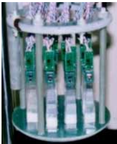
図2 センサアレイとデュワ内部構造
