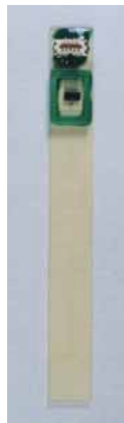
図1 薄膜グラジオメーター
