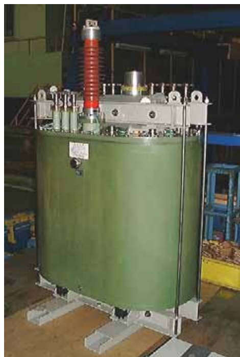
図 3 鉄道総研試作の新幹線車両搭載用変圧器 (1φ-25 kV /1.2 kV /0.4kV-4MVA )
