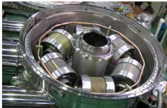
図 3 容器に収納された超電導コイル
