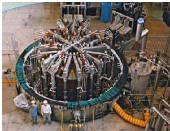
図 23 クライオスタット内に設置された CS モデルコイル
