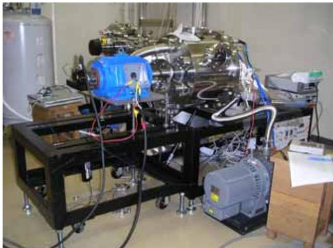
図1 アキシアルギャップ型バルク高温超電導電動機実証試作機
