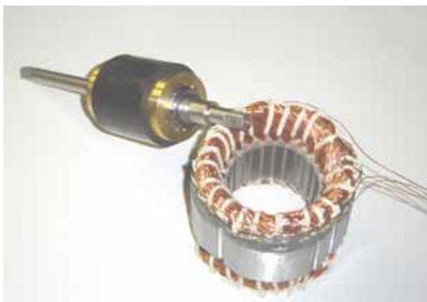
図2 製作したラジアル型電機子(右)と回転子(左: Sm-123 バルク材とシャフト)
