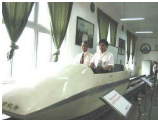
図1 中国の西南交通大学が開発した、バルク超電導体の磁気浮上を利用した5人乗りマグレブ。Fe-Nd-B磁石をガイドレールとしている。(西南交通大学パンフレット)
