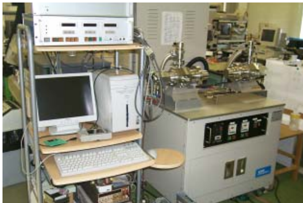
図2 アイシン精機が販売を開始したバルク超電導磁石を利用した磁場発生装置。自由空間に3T程度の磁場を発生できる。開発はイムラ材料開発研究所と名古屋大学が共同で行った。
