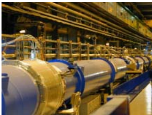
CERN 107mLHC 加速器試験 (2極マグネット×6+4極マグネット×2直列 4.5K)
