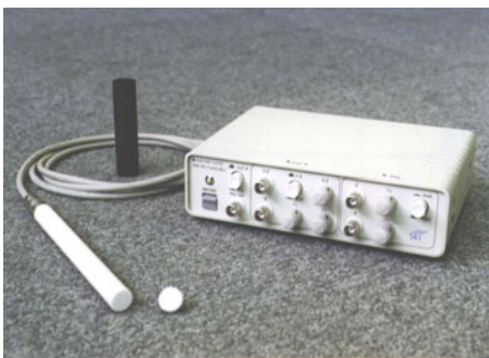
写真 高温超電導 SQUIDキット(住友電工ハイテックス製)
