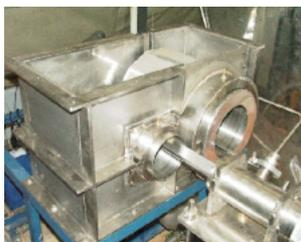
膜磁気分離槽 (処理量 100m<sup>3</sup>/日)
