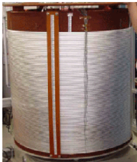
図1 超電導工学研究所が作製した 長尺高臨界電流YBCO線材 I_c \times L = 51,940 \text{ A} \cdot \text{m} 液体窒素での臨界電流 I_c = 245 \text{ A} 長さ(L) = 212m
