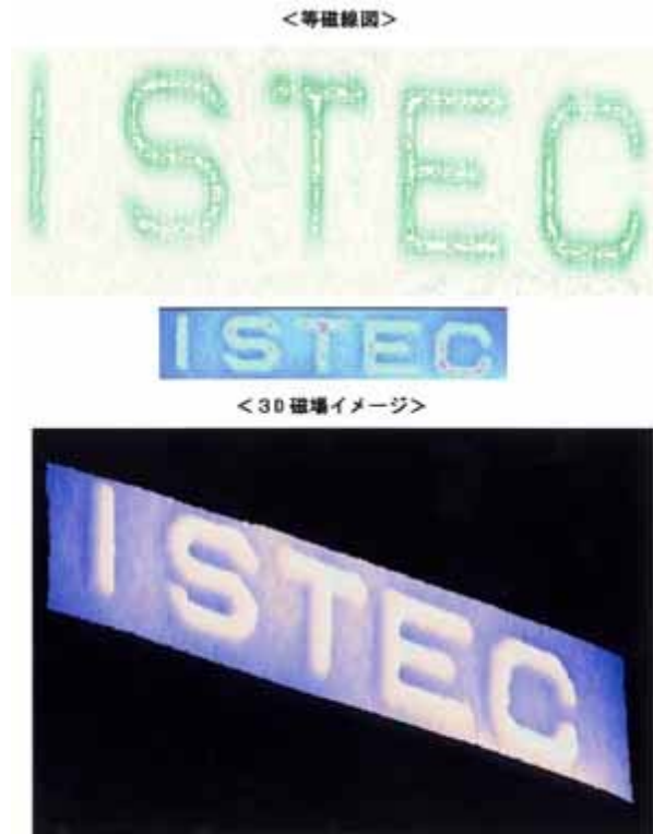
資料5 走査型SQUID顕微鏡システムを用い観察した超電導NBCO 薄膜パターン(ISTEC文字)の磁気分布。観察温度は4.2K
